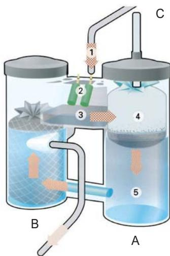
Le condensat ①, passe dans le silencieux ②, et entre dans la chambre de détente ③.
