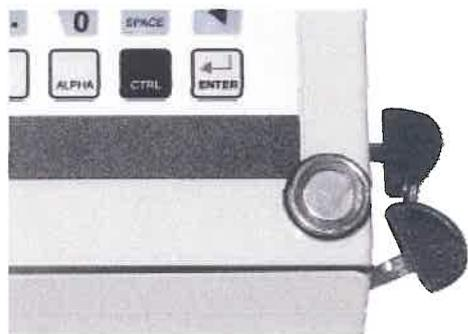
En bas à droite du clavier, se trouve le lecteur de clé magnétique (sous forme de petit cylindre argenté avec un bord noir) qui permet d'entrer des données en approchant une clé magnétique.
