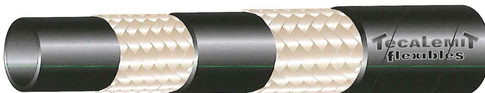
Le tuyau T211 destiné au transport de l'huile hydraulique sous fortes pressions, possède deux tresses métalliques. Son aspect est bandelé fine toile, son revêtement mince permet un sertissage sans dénudage des douilles à sertir appropriées. Polyvalent et facile à mettre en oeuvre, il est toujours disponible chez nos distributeurs. ce tuyau peut être fabriqué avec un revêtement anti-abrasif: il porte alors la référence T212.
